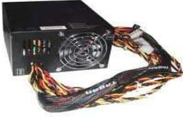
عمله تزويد الحاسوب بالطاقة الكهربائية، ويقوم بتحويل الجهد الكهربائي المتردد ما بين 220 فولت و120 فولت إلى جهد مستمر أقل للوحة الأم يتراوح بين 5 فولت، 12 فولت و33 فولت.
