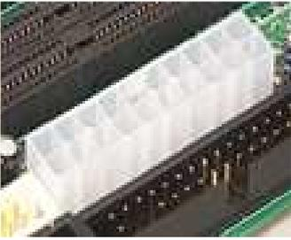
أ-مقبس توصيل الطاقة (Power Connector): عبارة عن مقبس أو منفذ به عدة ثقوب دوره الاتصال بكابل بهدف إيصال التيار الكهربائي للوحة الأم حتى تتمكن من العمل.
