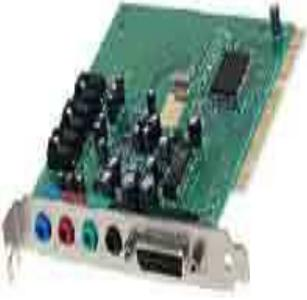
وظيفتها معالجة الصوت أثناء خروجه أو دخوله من وإلى اللوحة الأم أو الحاسوب أي أنها تضاف لإمكانية التعامل مع الصوت في الحاسوب، تتركب هذه البطاقة عادة على فتحة توسعة من النوع PCI وتستخدم هذه البطاقة لتوصيل مكبرات الصوت، من خلال الوصل بالفتحة LINE OUT ولاقط الصوت Microphone من خلال الفتحة MIC وأيضاً عصى الألعاب Joystick الخاصة بتشغيل الألعاب، بالإضافة إلى إمكانية إدخال الصوت من أي مصدر للصوت من خلال فتحة LINE IN الموجودة على كرت الصوت.
