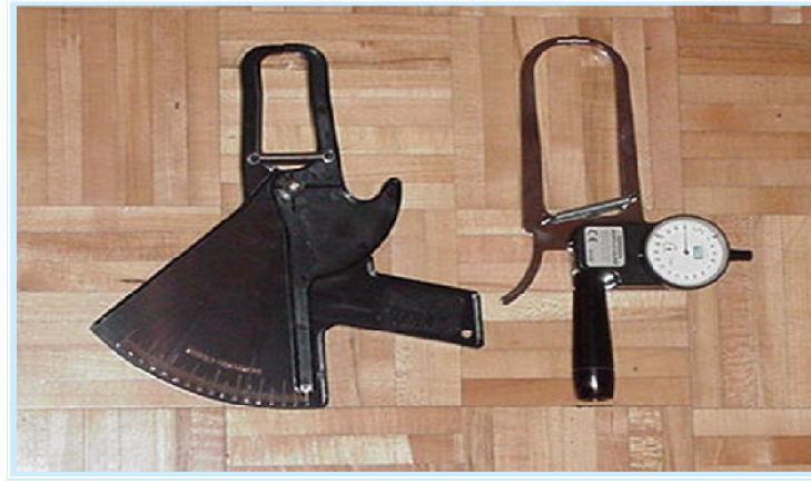
الشكل (14): تمثل جهاز قياس ثنايا الجلد (Skinfold Calipers) 1 .
