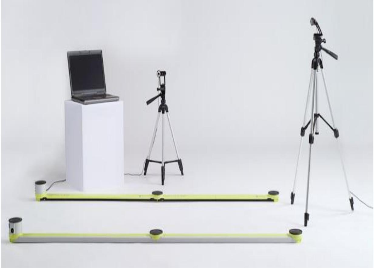
شكل رقم (20) شكل يوضح صورة جهاز optojump
