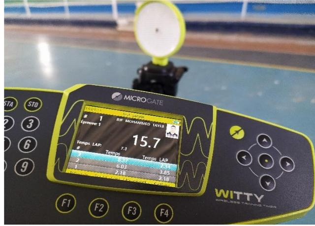
الشكل رقم (07): يوضح جهاز الخلايا الضوئية micro gate
